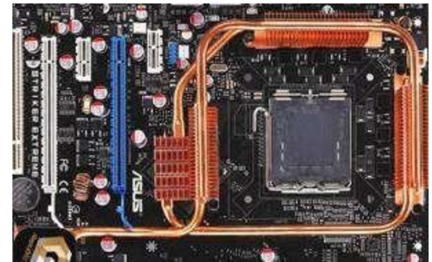
Ventilació Heat-Pipe per xipset
